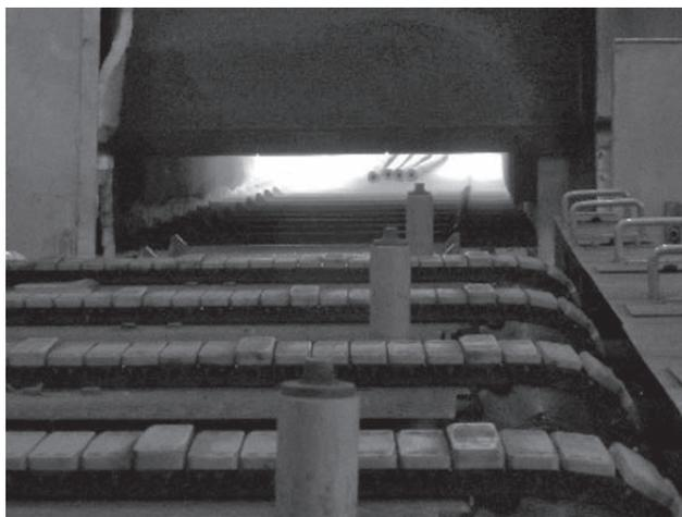
図1 固溶化熱処理炉の外観
