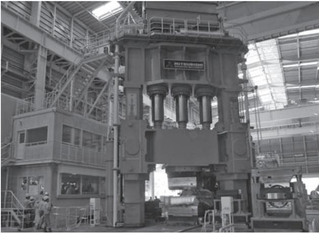
写真1 5000T鍛造プレス外観
