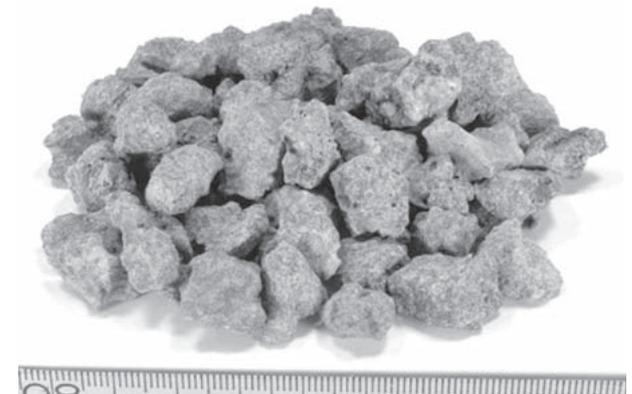
図1.製鋼スラグ（電気炉スラグ）製品の外観写真
