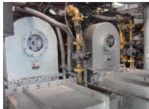
図10 鍛造加熱炉に導入したリジェネバーナー
