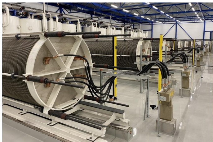
OVAKO水素プラントの電解装置
