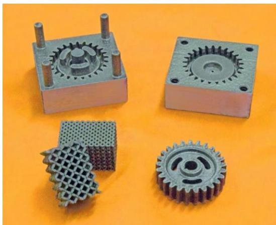
■ 開発鋼 Coフリーマルエージング鋼粉末による造形例
