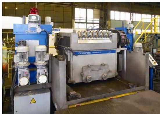
フェイズドアレイ超音波探傷機
