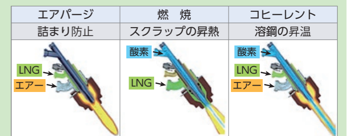
新設したバーナーの使用モード別概略図
