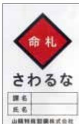
機械設備などの稼働区域に入るときは、機械への巻き込まれや誤操作を防ぐため、機械を停止させ、機械のスイッチ等に、「命札」を本人が取り付け、本人が外すという基本ルールの徹底に取り組んでいます。
