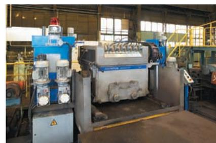
棒鋼用フェーズドアレイ式超音波探傷設備
