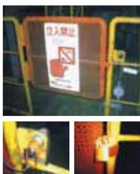
設備稼働区域では、作業者が誤って機械を止めずに侵入するのを防ぐため、安全柵、安全プラグスイッチ（扉を開けると自動的に設備が停止）の設置、扉の施錠を行い、ヒューマンエラーによる災害を防止しています。
