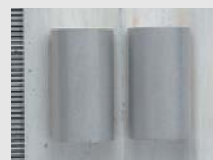
SUS316L造形体の 5%塩酸浸漬試験後の TP外観
