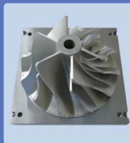
テストピースおよび実機相当部品の造形試作例
