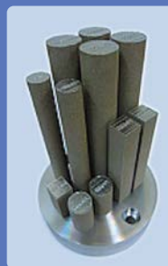
テストピースおよび実機相当部品の造形試作例
