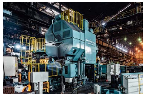
1600t プレス・ローリング0号 1600t press and No.0 rolling mill
