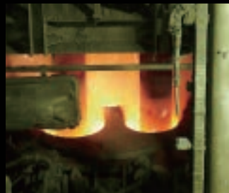
取鋼精錬設備 [LF]
