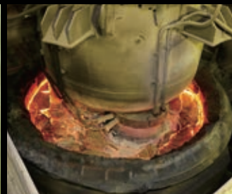
RH真空脱ガス設備
