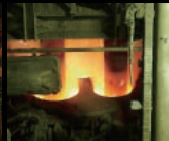
取鋼精錬設備 [LF]
