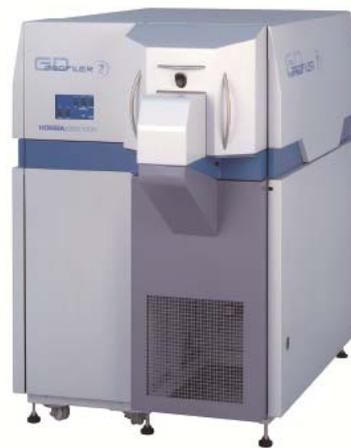
図1 グロー放電発光分析装置の外観
