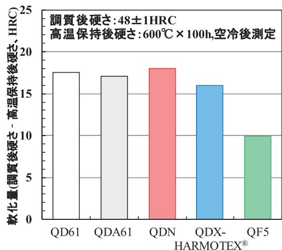
図4 QD61, QDA61, QDN, QDX-HARMOTEX<sup>®</sup>, QF5の軟化抵抗性
