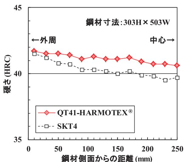
図9 QT41-HARMOTEX®の実体熱処理材の断面硬さ分布
