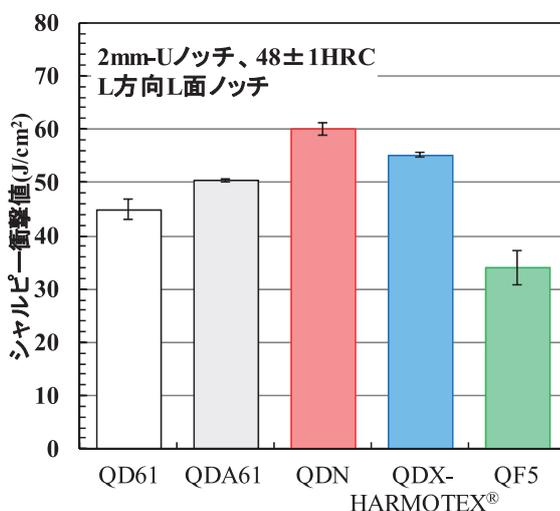
図3 QD61, QDA61, QDN, QDX-HARMOTEX<sup>®</sup>, QF5のシャルピー衝撃特性
