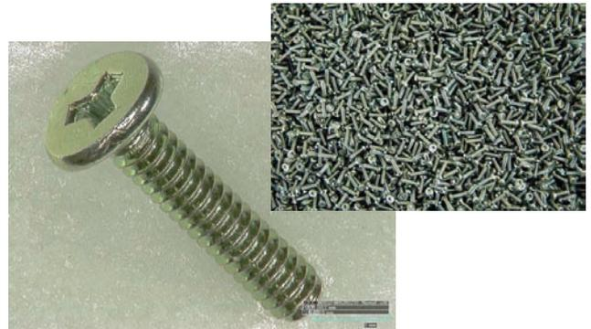
図16 超微細粒組織M1.7ねじの外観<sup>19)</sup>
