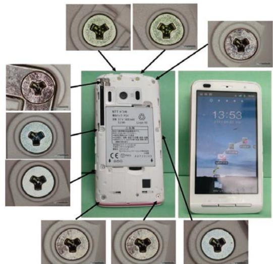
図18 スマートフォンに採用された超微細粒組織を持つM1.6高強度精密ねじ<sup>20,21)</sup>
