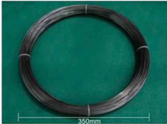
図14 超微細粒組織線材 (直径3mm) コイルの外観<sup>40, 43, 44)</sup>
