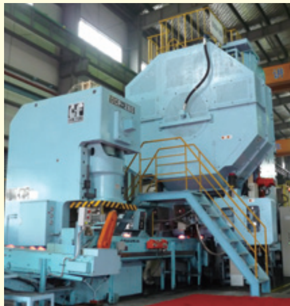
中国素形材子会社に新設した2000トン縦型プレス機
