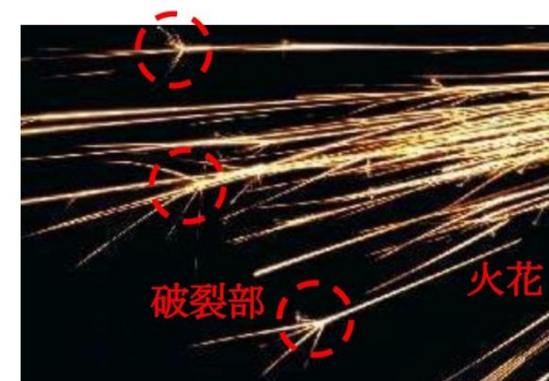
火花および破裂部の例
