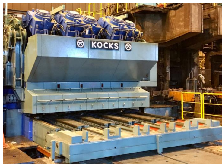
RSB圧延機の外観
