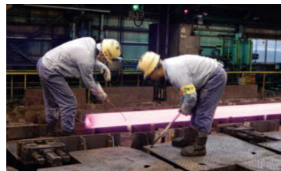
技能伝承の様子(熱鋼状態での寸法チェック)
