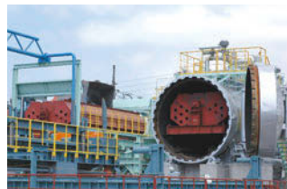
加圧式蒸気エージング設備
