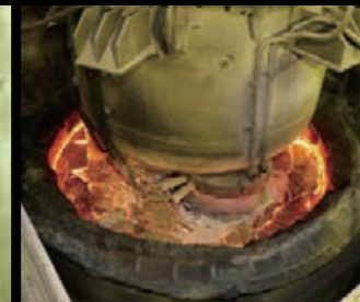
RH真空脱ガス設備
