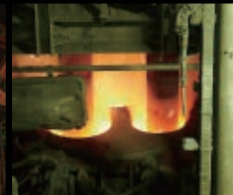
取鋼精錬設備 [LF]
