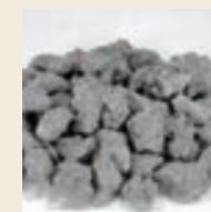
Electric arc furnace slag
