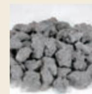
Electric arc furnace slag
