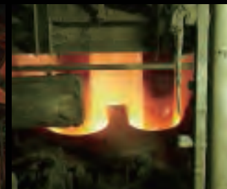
取鋼精錬設備 [LF]
