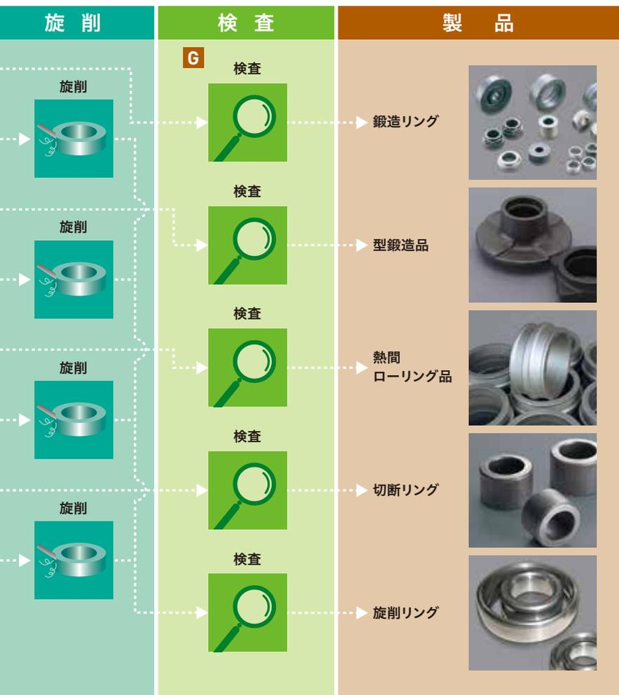
山陽特殊製鋼は、国内および海外のグループ会社で高品質の素形材製品を素材から一貫生産しています。ニーズに応じた最適な工程で、お客様における加工工程の合理化と歩留まりの向上に貢献する、素形材製品を製造しています。
