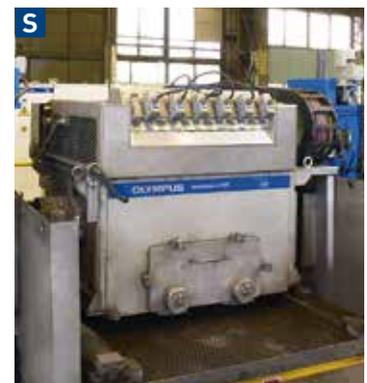
【棒鋼用フェイズドアレイ超音波探傷機】
