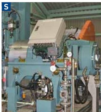
【鋼管用水浸超音波探傷機】
